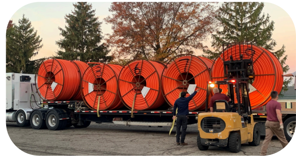
Orange 2in. Plastic Conduit
